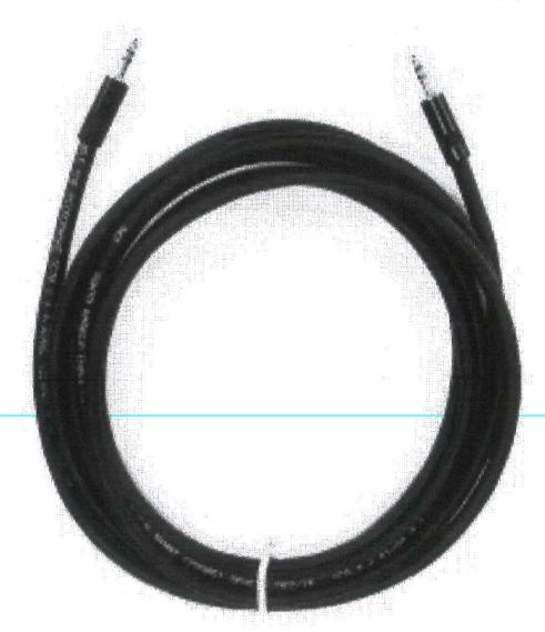
Cabo de microfone balanceado com liga de Cobre OFHC (Isento de Oxigênio), blindagem em fita de alumínio + dreno, bitola 0,20mm²/24AWG - utilizado em estúdio.
