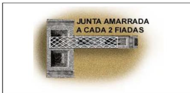
Figura 7: Junta com tela de aço entre alvenarias
