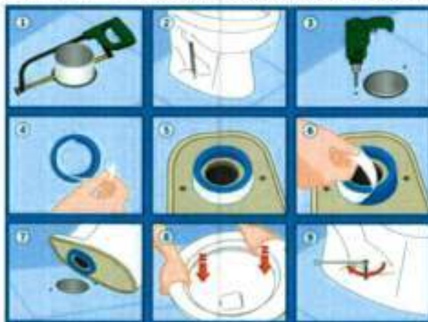
Figura 14: Processo de fixação das bacias sanitárias.
