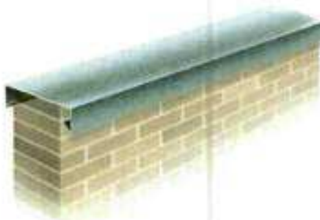
Figura 10: Execução do chapim finalizada
