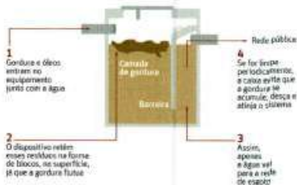
Figura 16: Funcionamento caixa de gordura simples em PVC.
