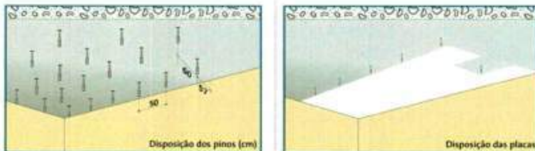
Figura 13: Detalhe fixação das placas de gesso
